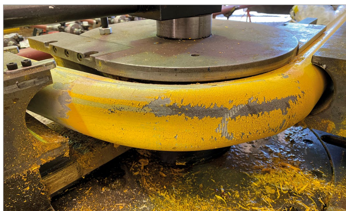
Biegen von lackierten Fernwärme Rohre
