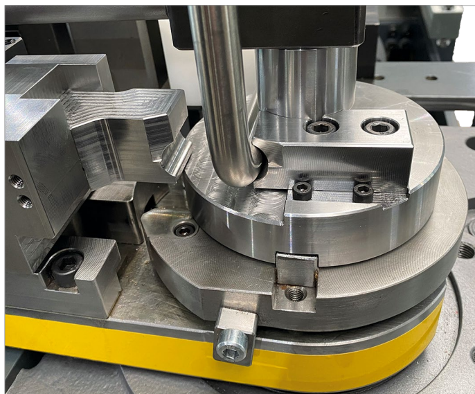
Biegen von Vollmaterial \varnothing 16 mm Radius 22 mm
