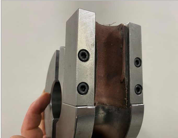
Schleifpapier einlegen
