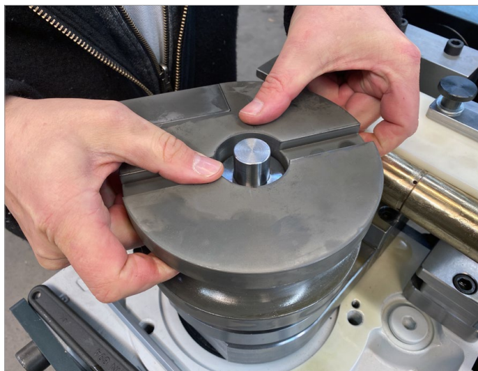
Biegewerkzeug wechseln
